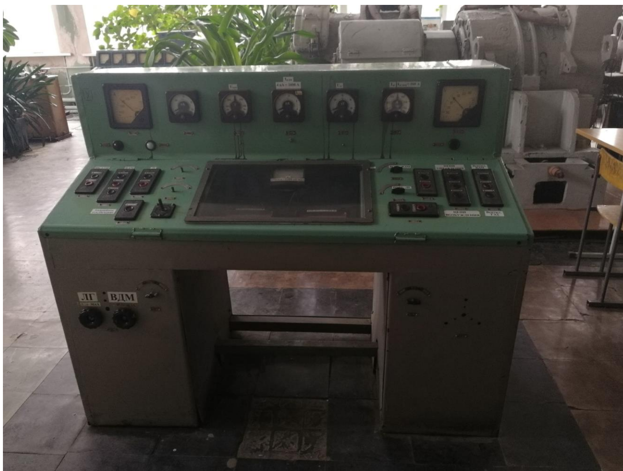
Лаборатория тяговых электрических машин. Стенд для исследования электромеханических и регулировочных характеристик тягового электродвигателя НБ-412М
