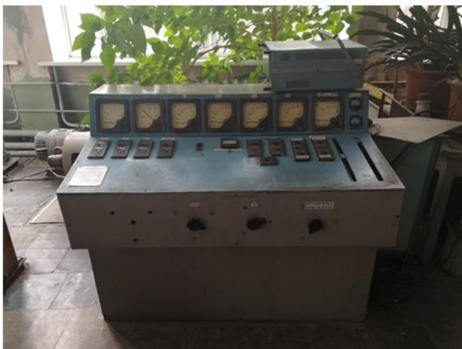
Лаборатория тяговых электрических машин. Стенд для исследования потенциальных условий на коллекторе тяговых электрических машин
