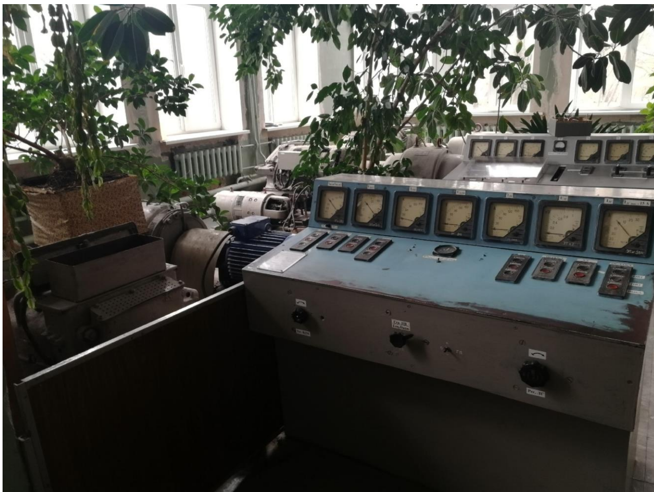
Лаборатория тяговых электрических машин. Стенд для исследования коммутации тягового электродвигателя (изучение искрообразования на поверхности коллектора)
