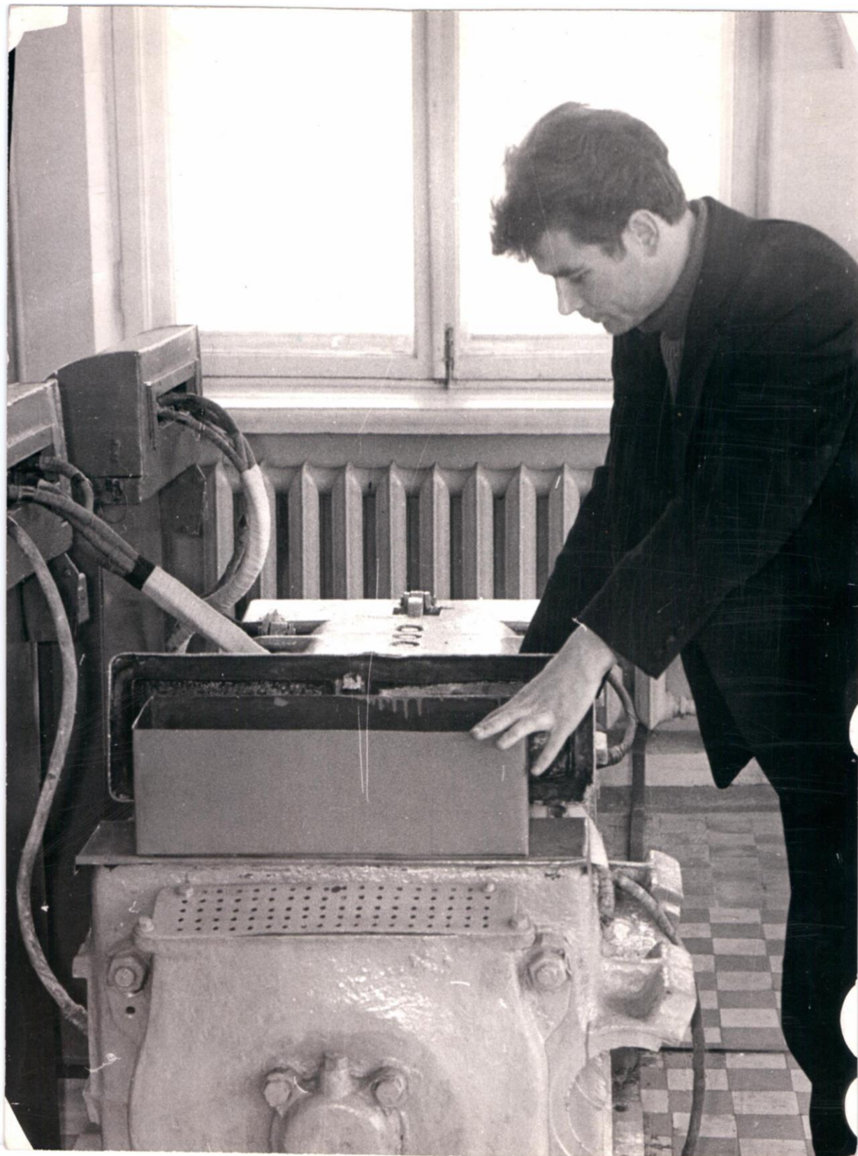
Лаборатория тяговых электрических машин. Вспомогательные машины стенда для исследования коммутации и потенциальной устойчивости тягового электродвигателя (изучение искрообразования на поверхности коллектора)
