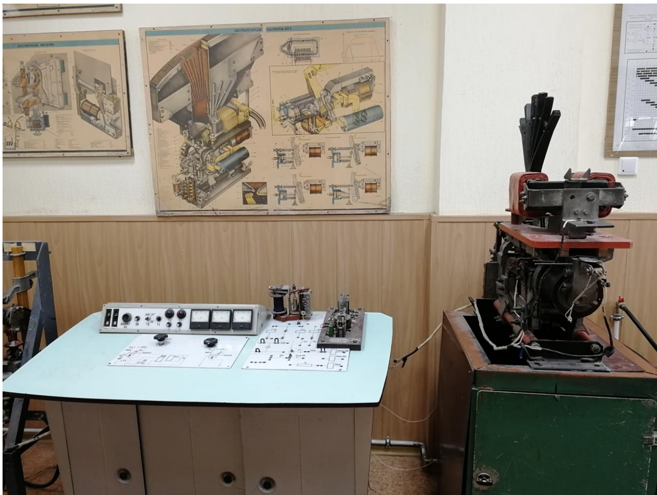
Лаборатория систем управления ЭПС. Стенд для изучения быстродействующего выключателя БВП-5
