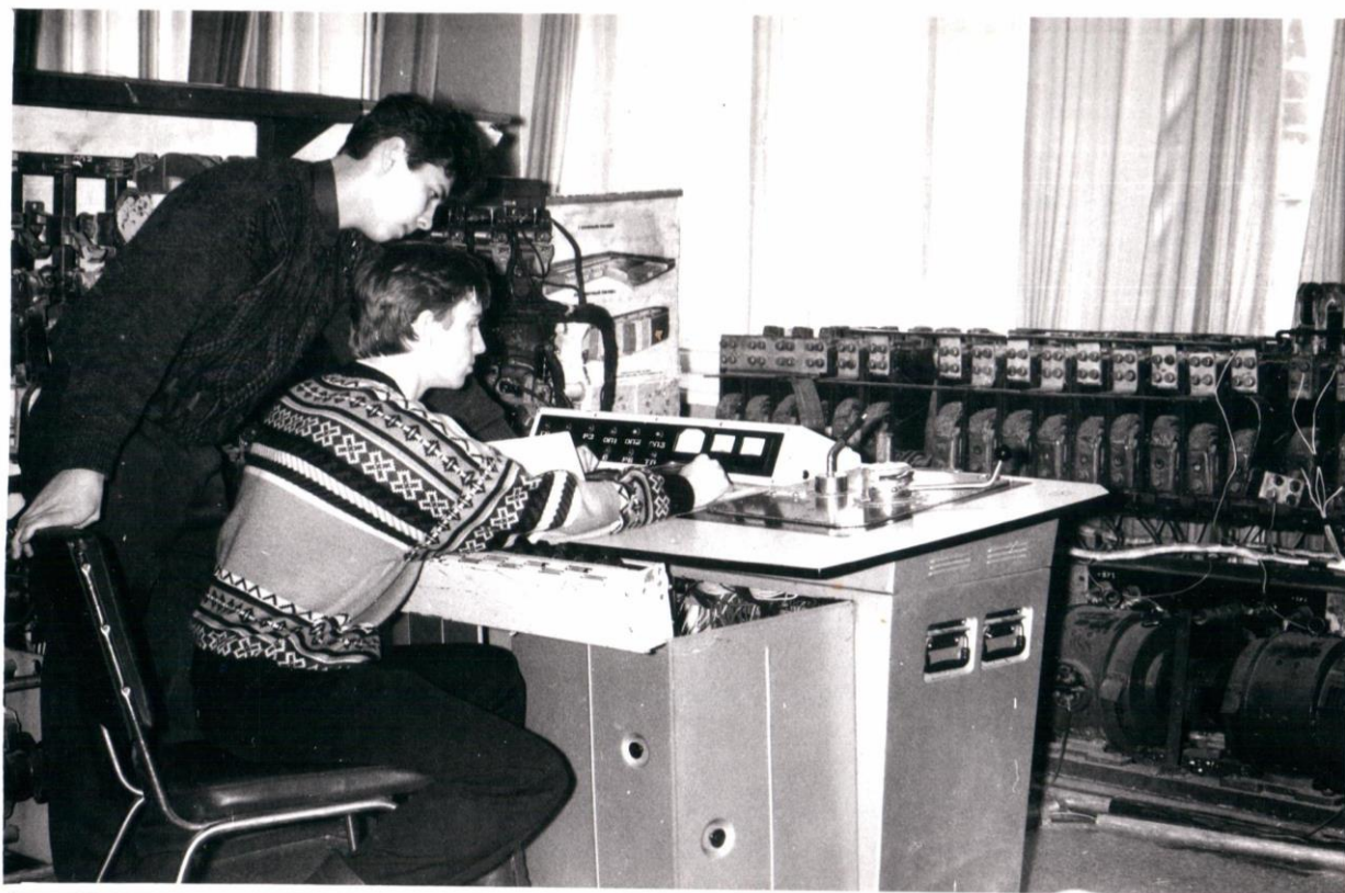
Лаборатория систем управления ЭПС. Стенд по электрическим аппаратам и системе управления электровоза ВЛ80С
