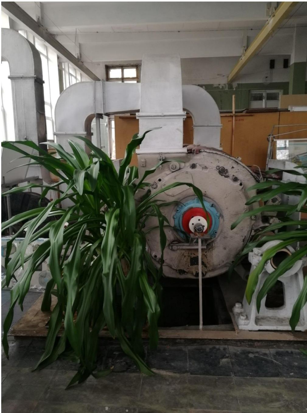
Лаборатория тяговых электрических машин. НБ-412М – тяговый электродвигатель пульсирующего тока электровоза ВЛ60. В лаборатории два тяговых электродвигателя используются в лабораторных работах по исследованию электромеханических характеристик методом взаимного нагружения и для определения расхода охлаждающего воздуха, поступающего для вентиляции при эксплуатации электровоза
