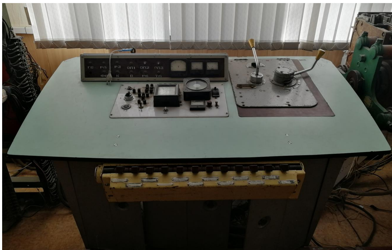
Лаборатория систем управления ЭПС. Пульт управления лабораторным стендом для изучения системы управления электровоза ВЛ80С
