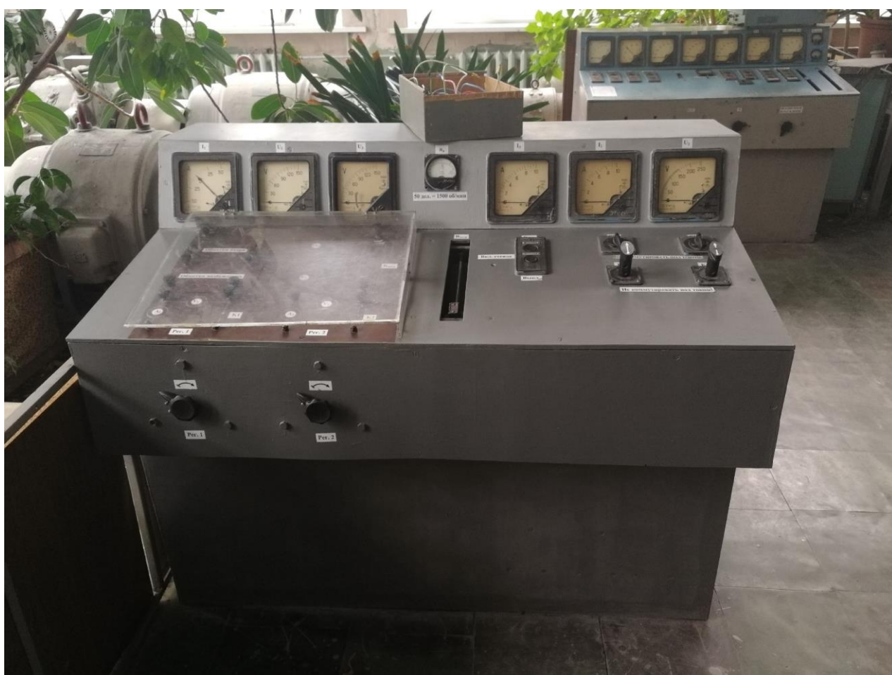
Лаборатория тяговых электрических машин. Стенд для изучения методов и схем испытаний тяговых электрических машин по методу непосредственного нагружения
