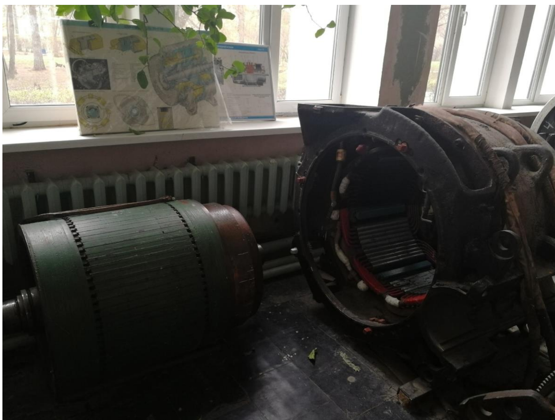
Лаборатория тяговых электрических машин. Макет для изучения конструкции тягового электродвигателя постоянного тока
